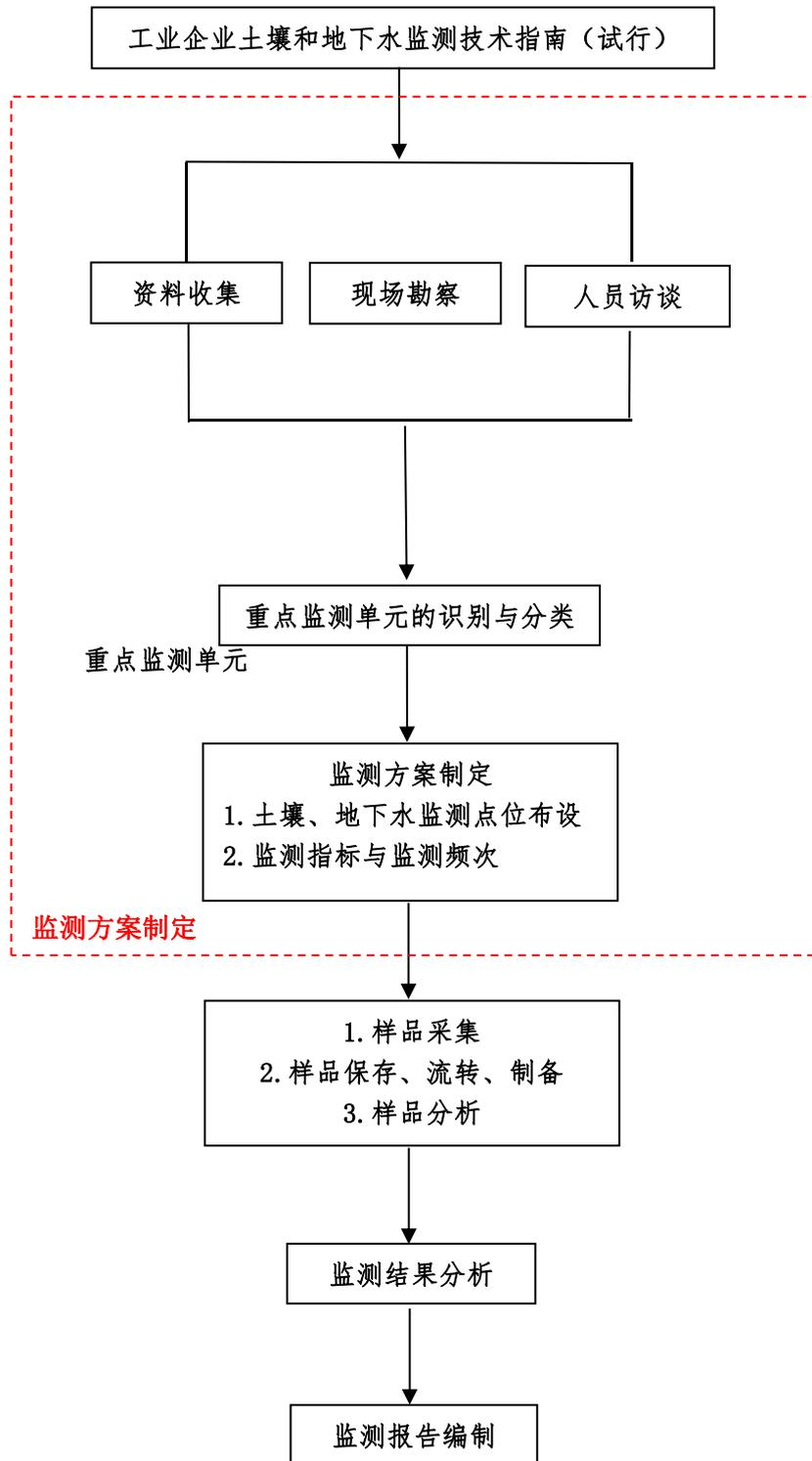
图 1-1 土壤和地下水监测工作技术路线图
