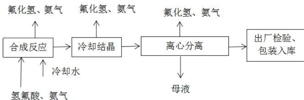
图 4-4 工艺流程图
