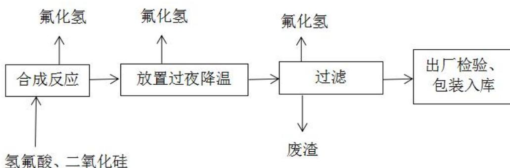
图 4-5 工艺流程图
