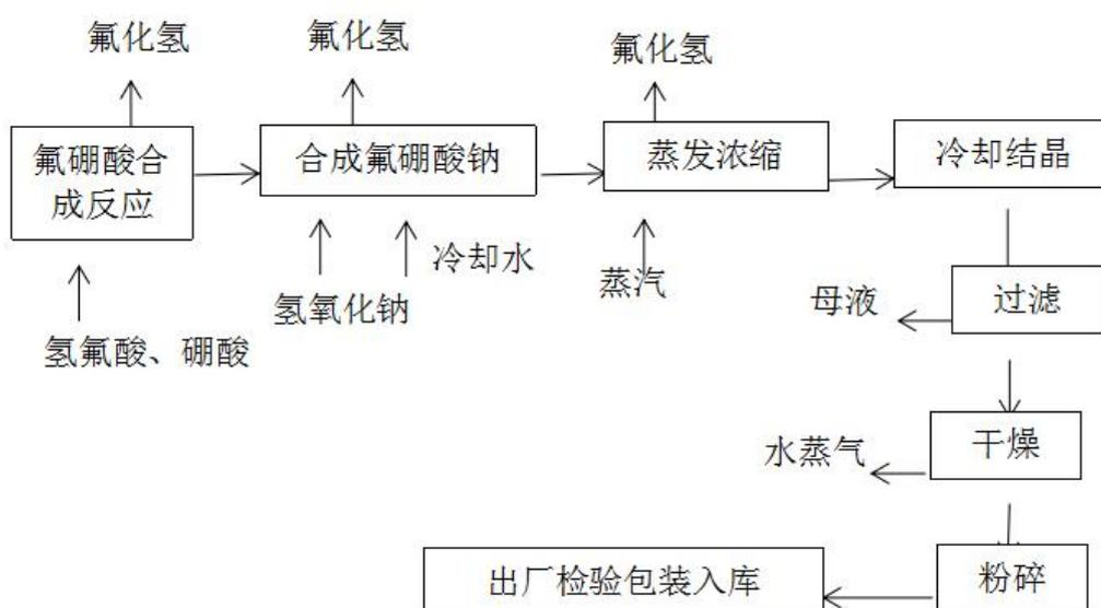
图 4-6 工艺流程图
