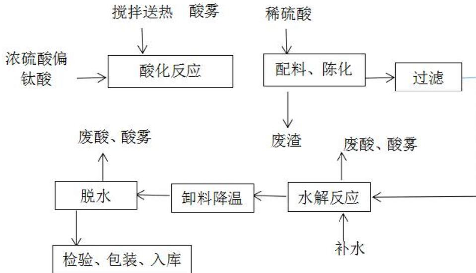
图 4-7 工艺流程图
