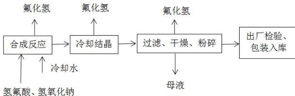
图 4-3 工艺流程图
